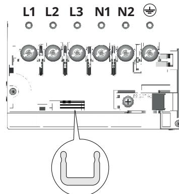
Sett strømshuntene inn mellom klemmene, som vist
