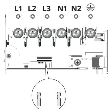
Zainstalować odgałęzienia pomiędzy zaciskami, zgodnie z ilustracją
