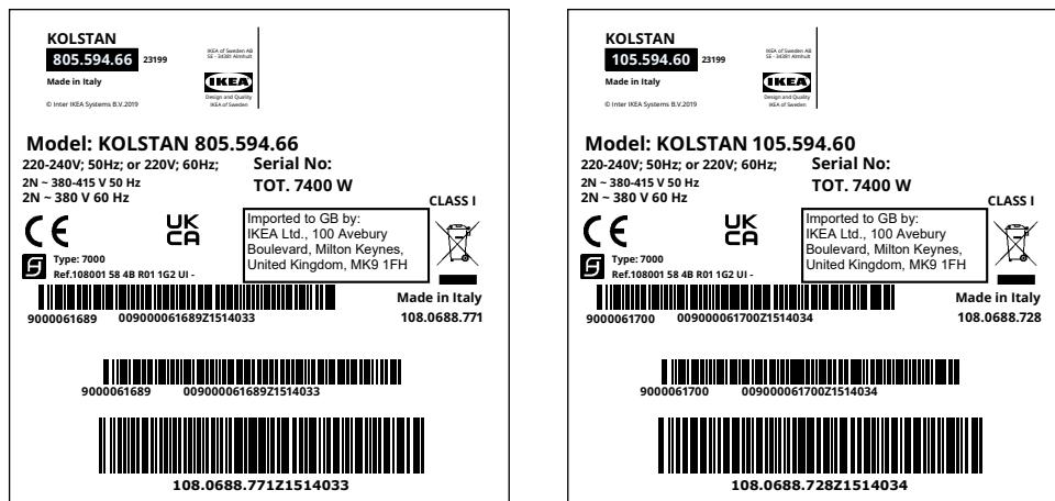
Das obenstehende Bild zeigt das Typenschild des Geräts. Die Seriennummer ist produktsspezifisch.
