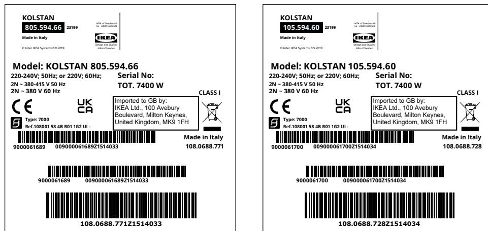
Ülaltoodud joonis kujutab seadme andmeplaati. Seerianumber on iga toote jaoks spetsiifiline. Luguteetud kasutaja, hoidke täiendav andmeplaat kinnitatuna tootes oleva ohutusbrošüüri kaanele.
