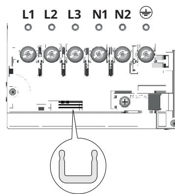
Akim şantlarını terminaller arasında gösterildiği gibi yerleştirin
