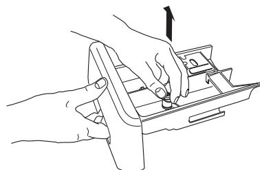
3. Oczyścić wszystkie części pod bieżącą wodą, starannie usuwając pozostałości detergentu i płynu zmiękczającego.
