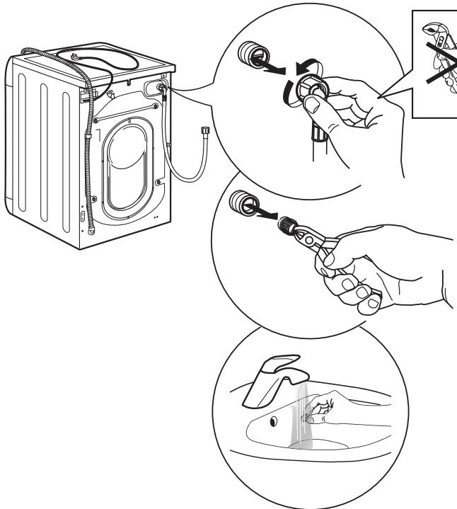
4. Z powrotem umieścić filtr. Z powrotem podłączyć wąż dopływowy do zaworu wody i pralki. Nie używać narzędzi do podłączenia węża dopływowego. Odkręcić zawór wody i sprawdzić, czy przyłącze jest szczelne.
