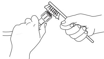
3. Następnie ręcznie odkręcić wąż dopływowy z tyłu pralki. Posługując się szczypcami wyjąć filtr siatkowy z zaworu znajdującego się z tyłu pralki i dokładnie go oczyścić.
