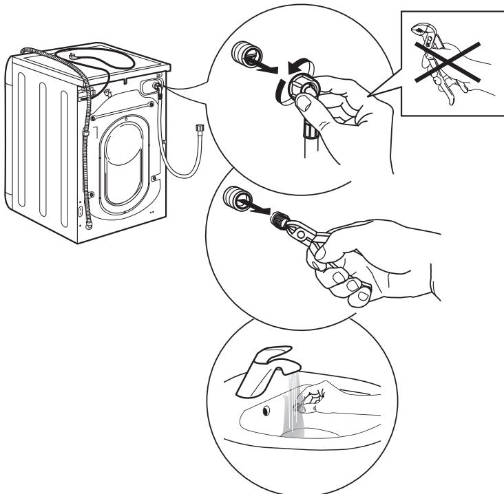
4. Установите сетчатый фильтр на место. Подсоедините заливной шланг к крану подачи воды и стиральной машине. Для подсоединения шланга не используйте инструменты. Откройте кран подачи воды и проверьте герметичность всех соединений.
