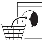
Przygotować pranie zgodnie z zaleceniami podanymi w części „PORADY I WSKAZÓWKI”. Otworzyć drzwi i załadować pranie do bębna, nie przekraczając maksymalnej ładowności wskazanej w „Tabeli programów”.
