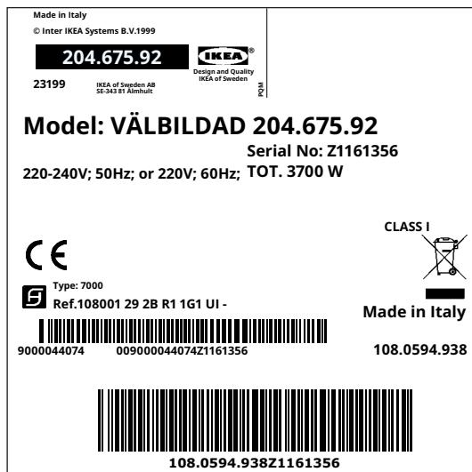
Ülaltoodud joonis kujutab seadme andmeplaati.
